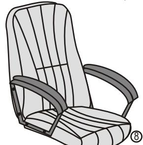
6. Сиденье установите отверстием в металлической площадке на газпатрон.
